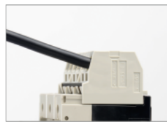
工具を取りはずし、接続完了確認 ※電線を軽く引っ張り(10N以下)、接続ができていることをご確認ください。
