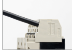
接続完了確認 ※カラー部が端子面より奥まで差し込まれていれば接続完了
