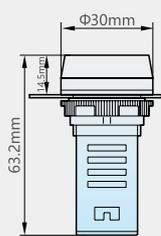
ND16-22B/2(C) AC/DC 6V 12V 24V 36V 48V 110V 220V 230V 240V 380V 400V
